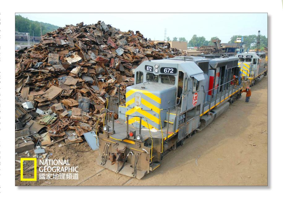
軌而言是過於沉重的負擔。他們需要有計畫地拆解火車頭,以 不破壞內部組件或附屬零件的方式切割鋼鐵,火車頭的設計幾 乎無法破壞。這列火車頭是由一百六十公噸的鑄鋼製造而成, 每塊鑄鋼都要用焊槍精準地拆解開來,拆解方式由上而下,分 為三個步驟。第一步,拆除外殼:切割拆除火車頭的鋼鐵外 殼,露出内部的動力核心。第二步,取出内部裝置:移除火車 頭的内部機件——原動機和發電機。第三步,最後的解體:切 除駕駛室,用焊槍切開超過七公分厚的鋼鐵火車頭底層,好拆 解輪胎和支架。這是一項需要經驗、技術和對火車頭心存敬意 的工作。
